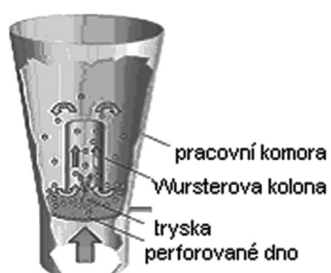
Obr. 4. Zařízení se spodním nástřikem (Wurster systém) (přepřacováno dle 15) )
