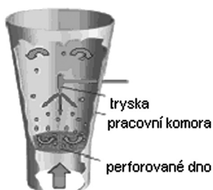
Obr. 3. Zařízení s vrchním nástřikem (přepřacováno dle 15) )
