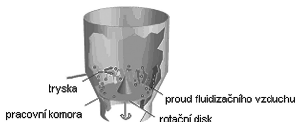
Obr. 5. Zařízení s tangenciálním nástřikem (přepřacováno dle 15) )
